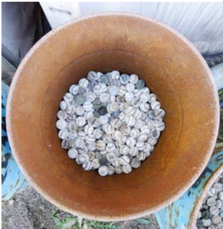
Foto 9 — Fusto con biglie di plastica usate per estrarre gli inquinanti sotterranei da un sito contaminato (Dunaújváros, Ungheria)
