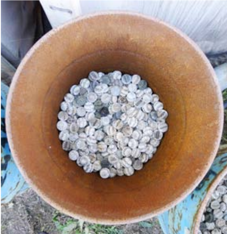
Φωτ. 9 — Βαρέλι με πλαστικές σφαίρες που χρησιμοποιούνται για την εξαγωγή των υπόγειων ρυπογόνων ουσιών από μολυσμένη εγκατάσταση (Dunaujvaros, Ουγγαρία)
