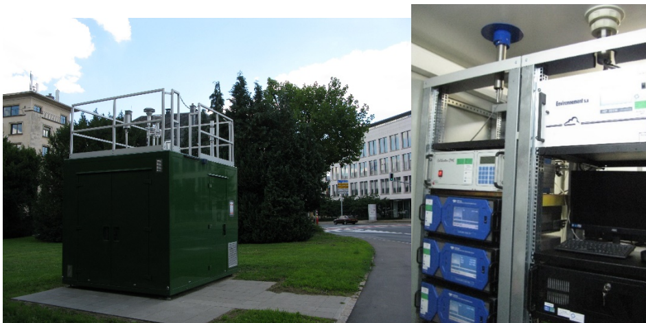
Levegőminőségi megfigyelőállomások és mintavételi pontok (a kék készülékek a jobb oldali képen)
